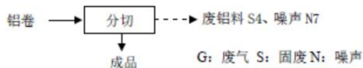
图 2-4 铝带生产工艺流程及产污环节图
